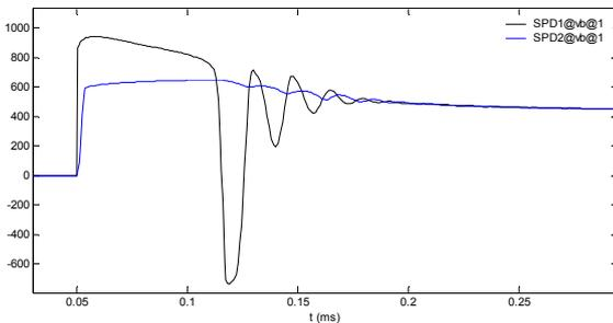
Fig. 9: the voltage’s waveform of the SPDs;SPD1:320v SPD2:275v
